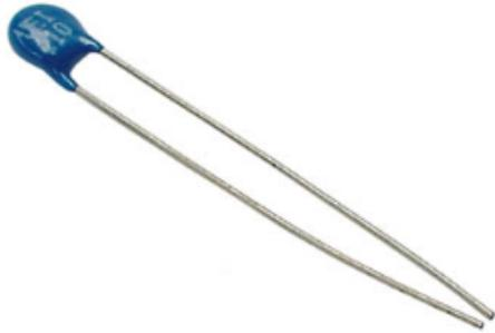
皮膚表面に直接装着して皮膚温を測定するものとして、一般によく使用されるのは、サーミスター (thermistor) である。サーミスターは大きな負の抵抗温度係数をもった半導体で、温度が上昇・下降すると、それにともない抵抗が減少・増加する。
